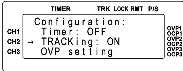
3. OVP setting：過電壓保護。按一下飛梭旋鈕之後，進入 OVP 的設定畫面。按”CH”鍵選擇那一 Channel，共有 CH1/CH2/CH3 可供選擇 (LCD 的左半邊有  $\rightarrow$  可指示)，按下 ON/OFF 鍵選擇是否啓動，再直接輸入設定的電壓，記得要按下飛梭旋鈕設定值才會儲存，OVP 功能就會啓動。
