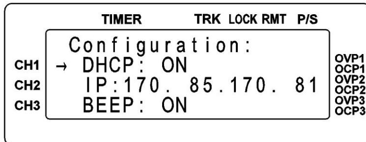
8. IP\*\*\*\*\*: 設定機器 IP 位址。按一下飛梭旋鈕之後，按下數字鍵，就可更改機器 IP 位址。
