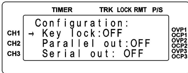
11. Parallel out : 並聯輸出。初始值為 OFF；按一下飛梭旋鈕之後，狀態更改為 ON。跳出 Config(設定)畫面之後，此時的 CH1 & CH2 內部正端相連、負端相連，原本任一 CH 可輸出 32V/3A 的電流，如今已可以輸出 32V/6A。
