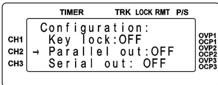
12. Serial out : 串聯輸出。初始值為 OFF；按一下飛梭旋鈕之後，狀態更改為 ON。跳出 Config(設定)畫面之後，此時的 CH1 正端和 CH2 負端短路，當作 COM 點，則 CH2 正端對 COM 有 +32V 的可設定電壓、CH1 負端對 COM 有 -32V 的可設定電壓。而 CH2 正端對 CH1 負端則有 64V 的電壓差。
